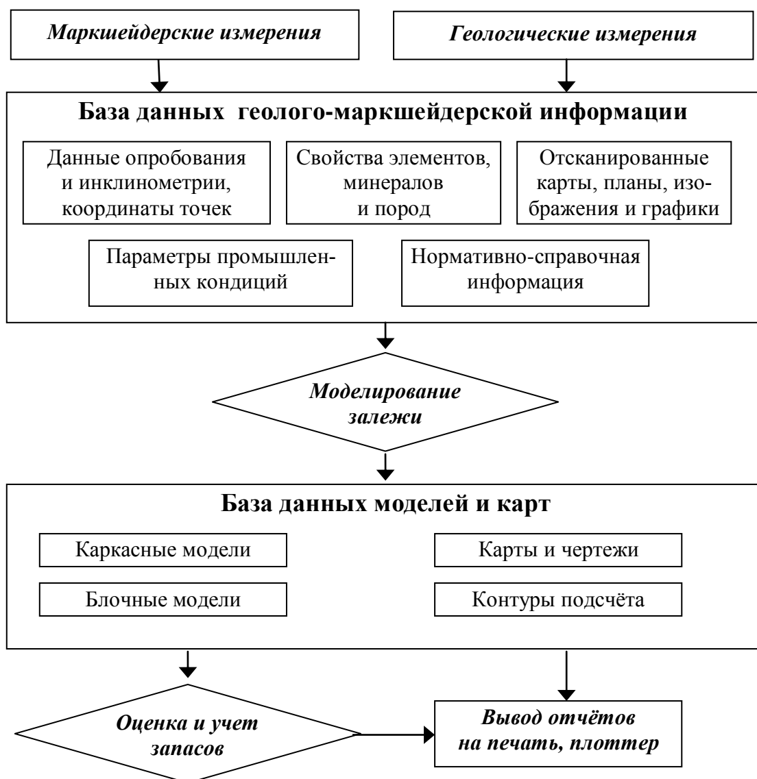
Рис. 3.13. Общая схема состава геолого-маркшейдерской БД и операций моделирования месторождения и оценки запасов
