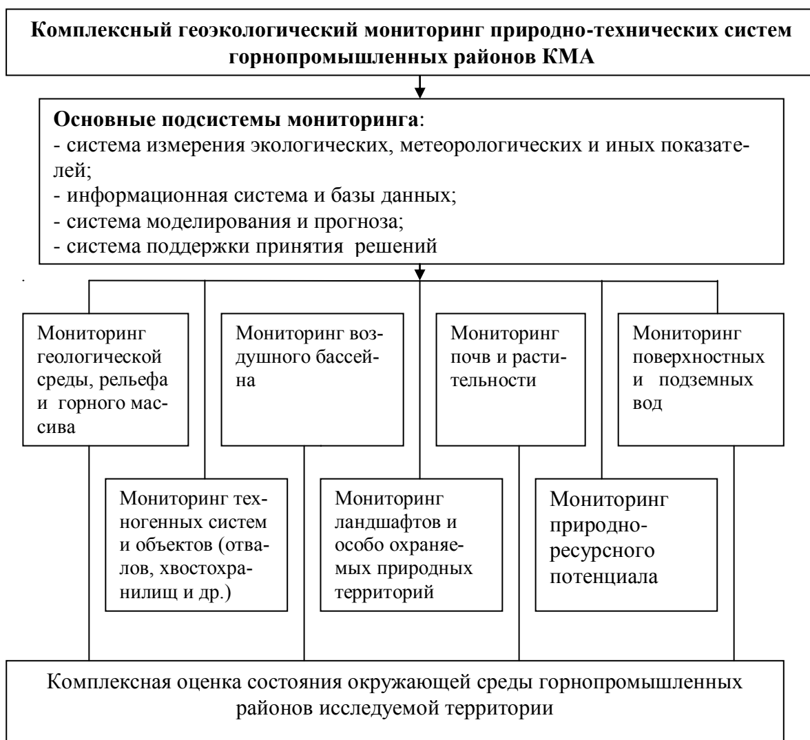
Рис. 5.5 Структурная схема комплексного геоэкологического мониторинга природно-технических систем горнопромышленных районов КМА
